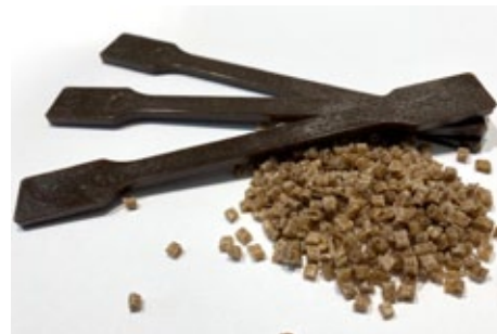
Reciklirane polimerne granule kot osnova za razvoj novih materialnih formulacij.
