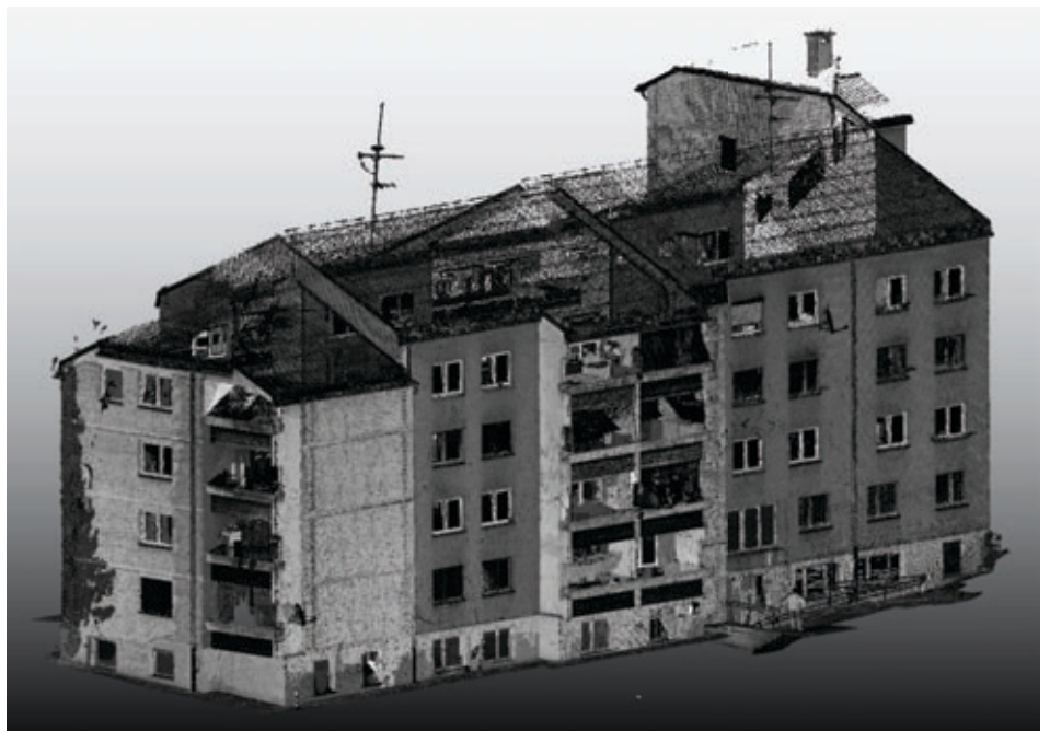
Posnetek točkovnega oblaka stanovanjskega objekta na Ravnah na Koroškem, Vir: arhiv EUTRIP, d.o.o.
