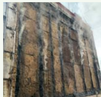
Stena Lumar po tem, ko je bila 92 minut izpostavljena požaru.
