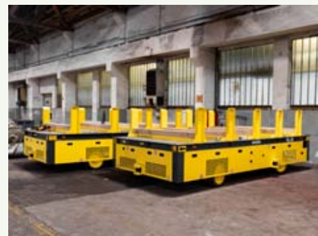
Nova električna baterijska vozička med obratovanjem ne povzročata nobenih izpustov, dodatno prednost omogoča tudi njuno tiho delovanje. (Foto: Arhiv SIJ Metal Ravne)
