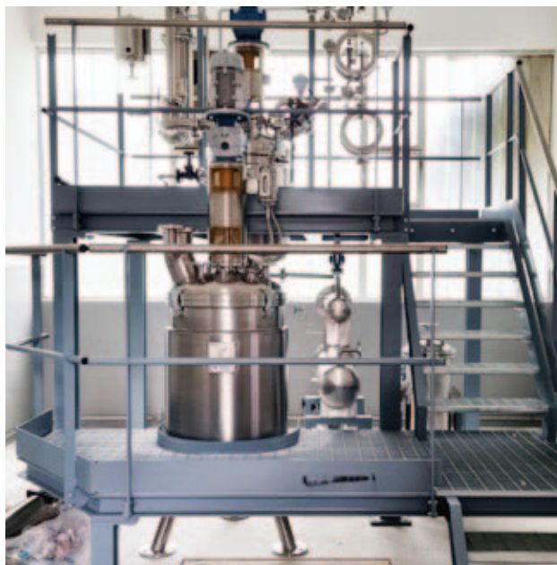
Namensko izdelana pilotna sintezna naprava s pripadajočimi instalacijami.
