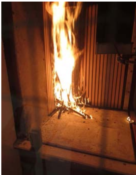
Slika 5: Preskus požarne odpornosti lesene obloge
