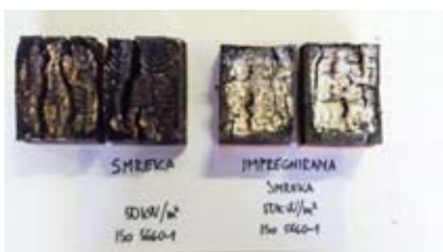
Slika 2: Primer naravnega lesa smreke (levo) in lesa smreke po postopku mineralizacije (desno) po preskušanju s konusnim kalorimetrom (ISO 5660-1) pri izpostavitvi toplotnemu toku 50 kW/m 2
