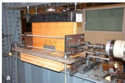
Slika 2: a) Postavitev preiskave za strižno obremenjevanje stika CLT panelov, b) Poškodbe preskušanca z izolacijo, c) Močno deformiran kotnik z vijaki po preiskavi
