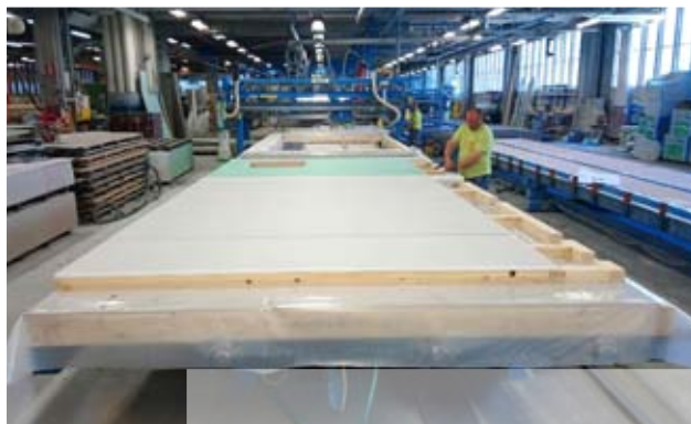
Slika 1: Izdelava lahkega lesenega okvirnega stenskega panela v proizvodnji (Jelovica hiše d.o.o.)
