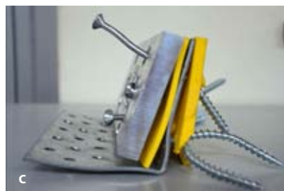
Slika 2: a) Postavitev preiskave za strižno obremenjevanje stika CLT panelov, b) Poškodbe preskušanca z izolacijo, c) Močno deformiran kotnik z vijaki po preiskavi
