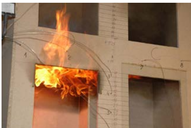
Slika 9: Sekvenca napredovanj požara po modelni leseni stavbi
