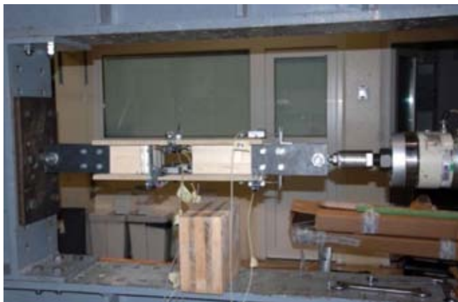
Slika 2: Preskuševališče z vzorcem (levo) in skica malih preskušancev za študij obnašanja stikov (desno)
