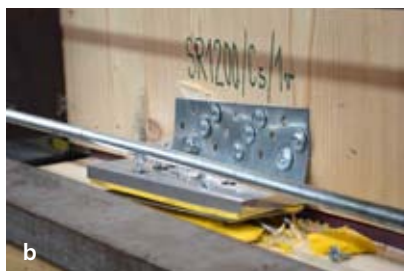
Slika 2: a) Postavitev preiskave za strižno obremenjevanje stika CLT panelov, b) Poškodbe preskušanca z izolacijo, c) Močno deformiran kotnik z vijaki po preiskavi
