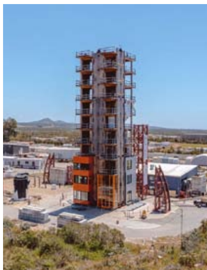
Slika 1: Preskušena desetnadstropna stavba: preskušanec na potresni mizi in shematski prikaz konstrukcijskega sistema stavbe (povzeto po Pei idr. 2023 in LEVER architecture).
