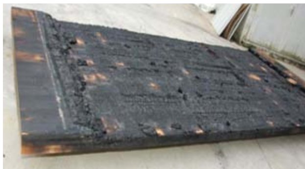
Slika 6: Nosilna lesena lepljena plošča po eni uri preskušanja pri polno razvitem požaru (na dveh nasprotnih robovih plošča ni bila izpostavljena pogojem požara)
