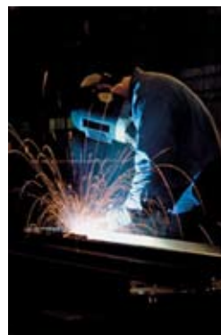
Slika 25: Pri varjenju se sprošča več milijonov nanodelcev na vsak \text{cm}^3 zraka.
