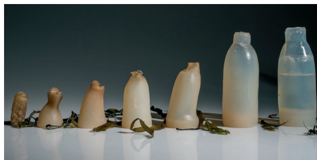
Slika 4: Koncept okolju prijazne, biorazgradljive plastenke za vodo, ki začne razpadati, ko se izprazni. Kot osnovni material je uporabljen derivat morske trave. Oblikovanje: Ari Jónsson Fotografiji: last Arija Jónssona, z dovoljenjem avtorja
