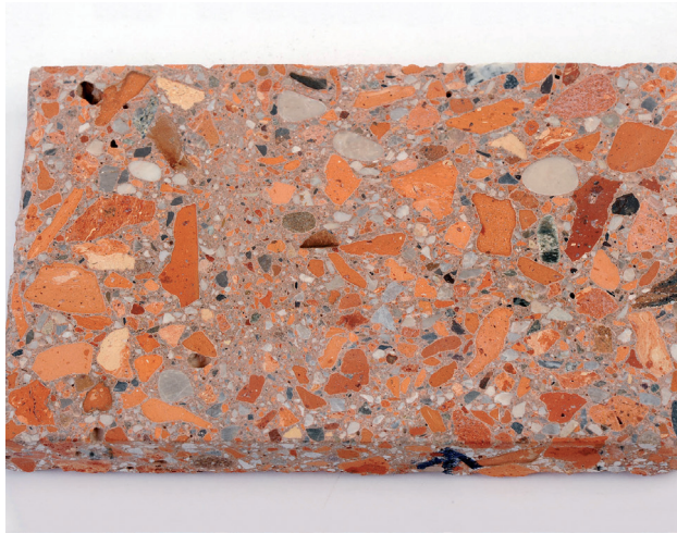
Slika 4: Beton z mešanico recikliranega agregata iz opeke in polnilom iz opečnega drobirja
