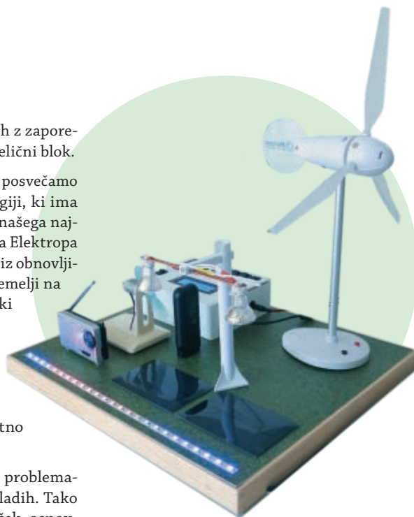
Maketa sončne in vetrne elektrarne s krmilno ploščo in porabniki ter baterijo za hranjenje energije
