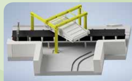
Lokacija vgrajenega separatorja na transporterju T-60
