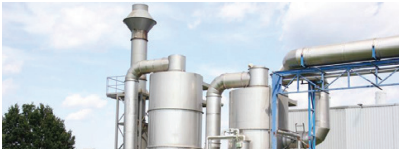
Pralnik plinov iz Fermentacije v Lendavi, kjer pranje poteka z vodo brez uporabe kemikalij za absorpcijo vonjav iz izpušnega zraka iz fermentorjev.
