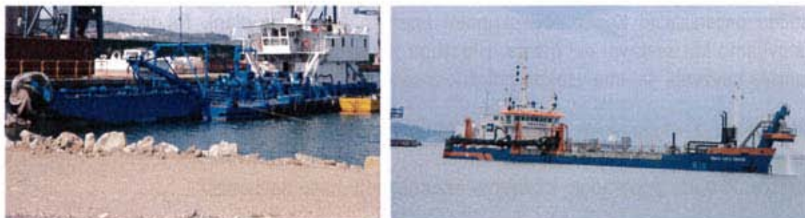
Slika 9. Na levi staro plovilo za poglabljanje, na desni pa novejšo in zmogljivejšo plovilo za poglabljanje
