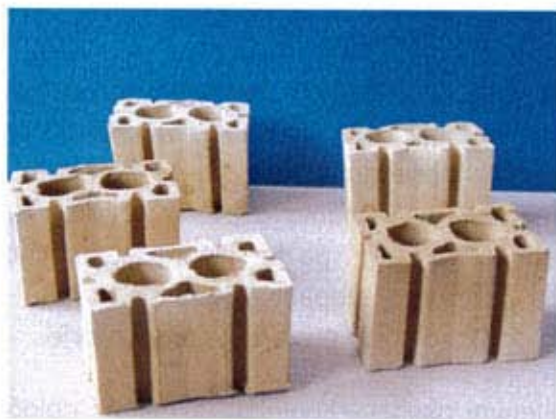
Slika 36. Laboratorijska opeka izdelana izključno iz morskega sedimenta
