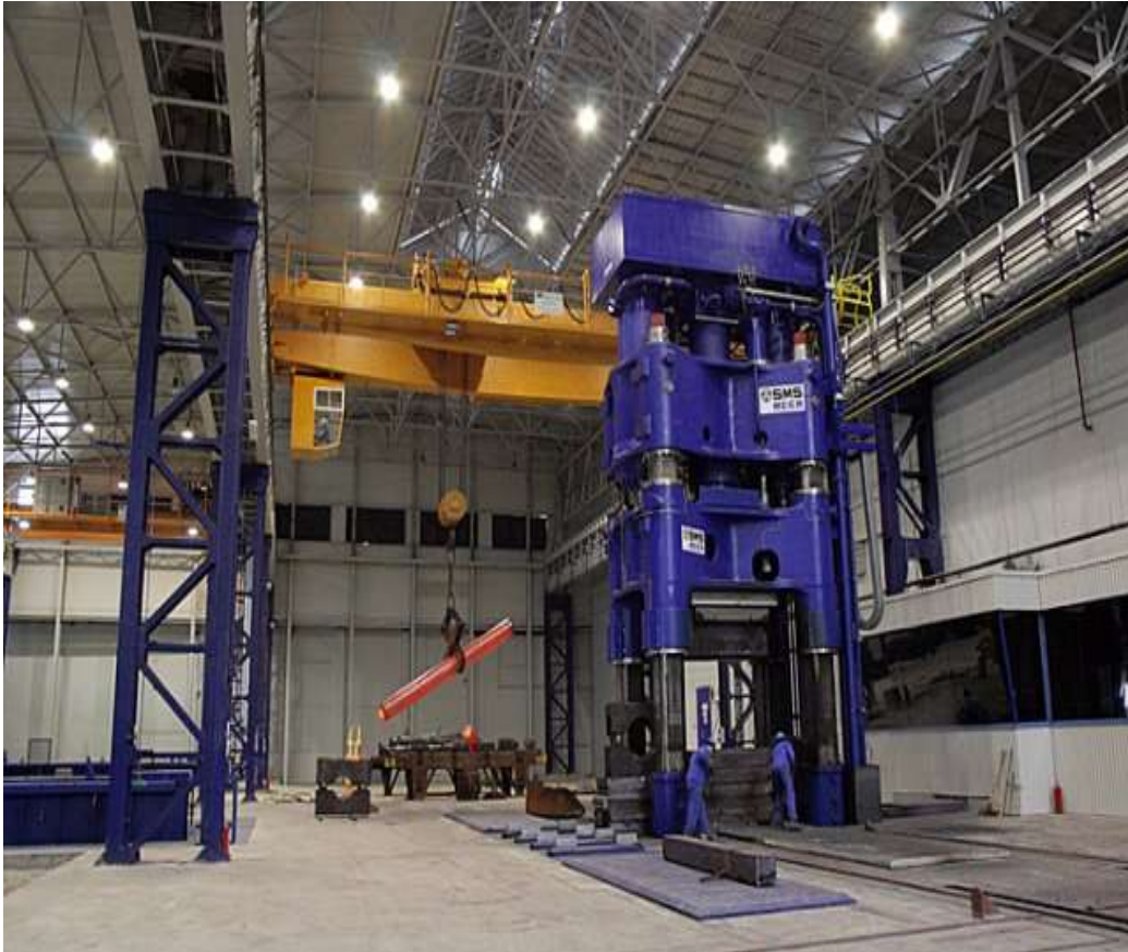
Slika 3 : Stiskalnica 40/45 MN v novi Kovačnici težkih odkovkov
