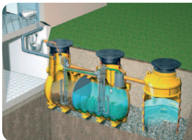
Slika 1: Mala komunalna čistilna naprava s ponikovalnikom
